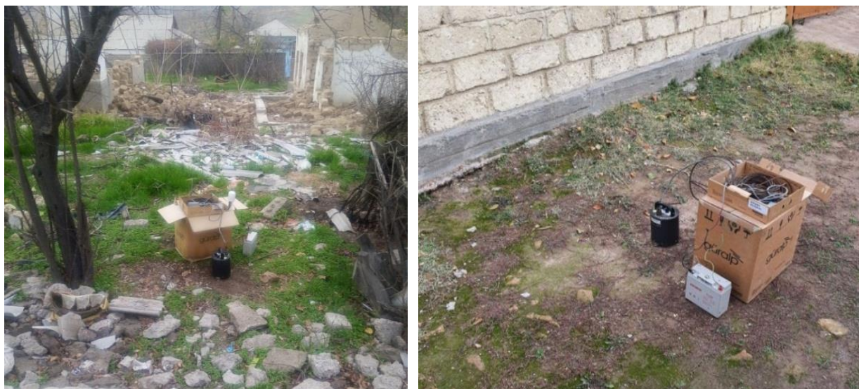
Рис. 3. Сейсмические приборы, установленные в населенных пунктах близ карьера Ёшлик I. Fig. 3. Seismic instruments installed in populated areas near the Yoshlik I quarry.
