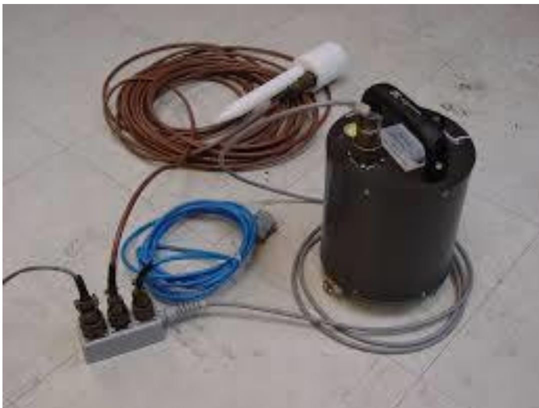
Рис. 1. Цифровой трехкомпонентный велосиметр CMG-6TD. Fig. 1. Digital three-component velocimeter CMG-6TD.
