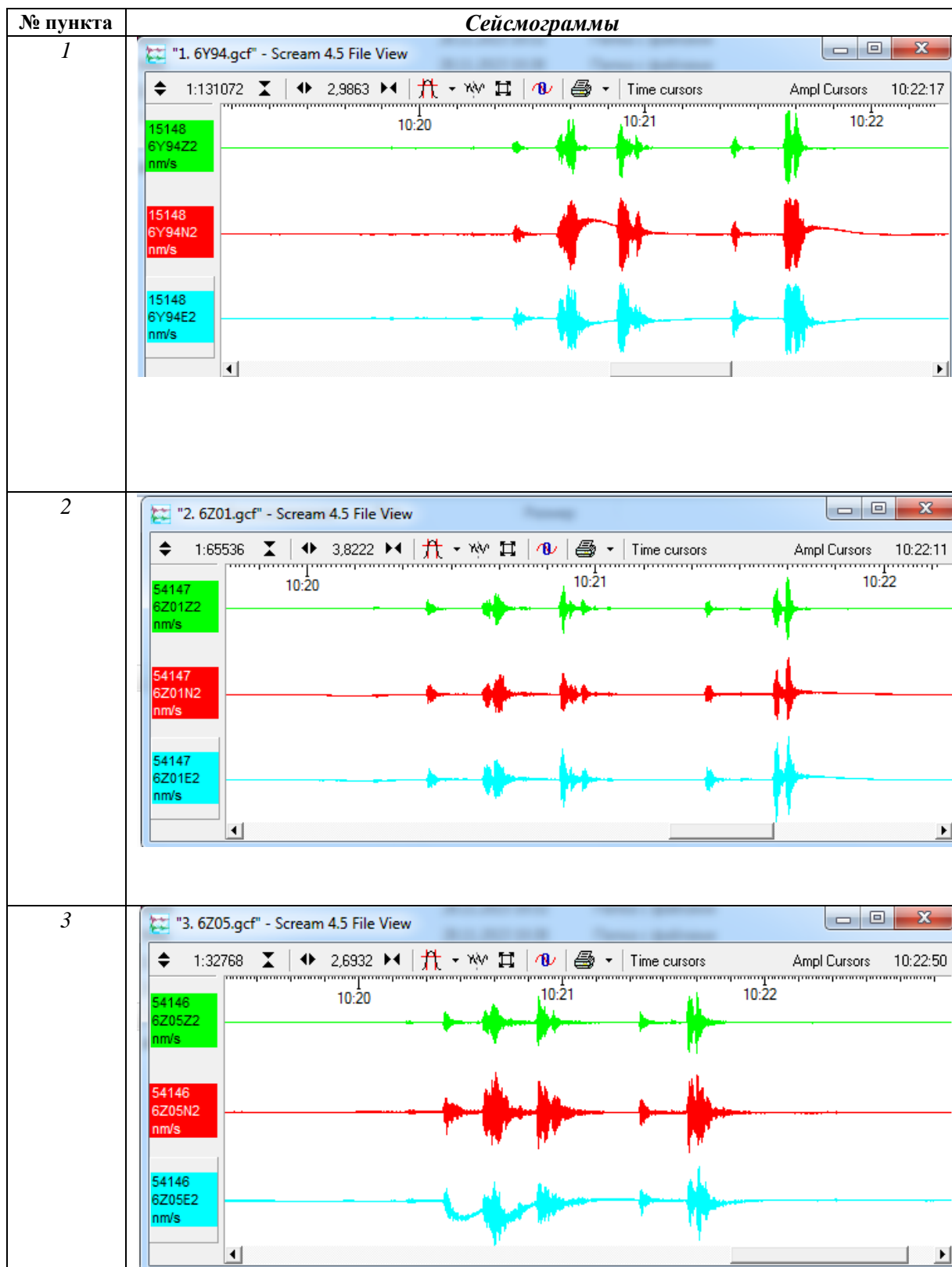
Рис. 4. Запись взрыва на пунктах регистрации. Fig. 4. Recording of an explosion at registration points.
